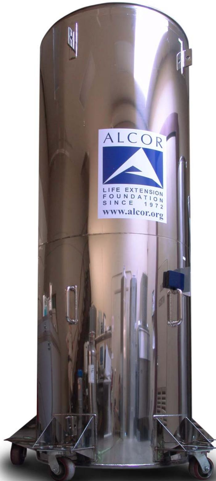
Un vaso Dewar para la criopreservación humana utilizado por Alcor Life Extension Foundation. Está diseñado específicamente para albergar cuatro cuerpos completos de pacientes y seis neuropacientes sumergidos en nitrógeno líquido a  $-196\text{ }^{\circ}\text{C}$ . El vaso Dewar es un recipiente aislado que no consume energía eléctrica. Periódicamente se añade nitrógeno líquido para reemplazar la pequeña cantidad que se evapora.
